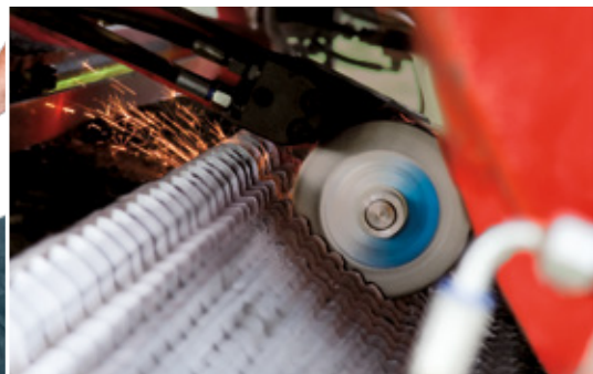
AUTO CUT – Vollautomatische Messerschleifeinrichtung direkt am Ladewagen.
