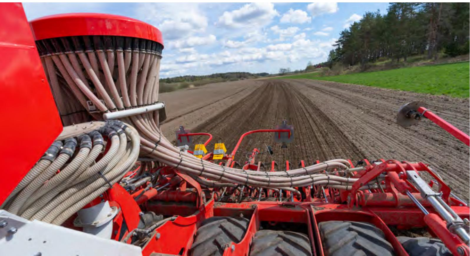
Der bewährte Reifenpacker erledigt bereits vor dem Schar die notwendige Rückverfestigung und schafft somit perfekte Keimbedingungen für das Saatgut. Die Rückverfestigung ist notwendig, denn der vielfach überlockerte Boden muss wieder Anschluss an den feuchten Unterboden finden, damit der kapillare Wasseraufstieg hergestellt wird und das Saatgut an die notwendige Keimfeuchtigkeit gelangt.
