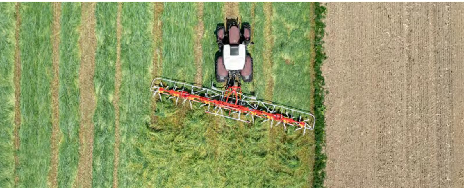
Für eine saubere Zettarbeit bis an die Schlaggrenze setzen wir von PÖTTINGER auf ein System, welches am Feldrand das Futter gleichmäßig in das Grundstückinnere streut, ohne Haufen oder gar einen Schwad zu bilden. Durch aktives Schrägstellen aller Räder nach links bzw. rechts läuft der Zetter schräg nach und streut das Futter homogen zur gemähten Fläche. Angrenzende Bestände bleiben unberührt. Die Fahrtrichtung spielt dabei keine Rolle.
