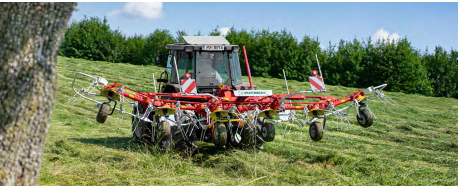
Am Vorgewende besteht hohe Gefahr, dass bei der ausgehobenen Maschine die Außenkreisel am Boden kratzen und die Grasnarbe beschädigen. Je nach Bedarf und Hubhöhe des Traktors bietet PÖTTINGER deshalb zu jedem Modell perfekt abgestimmte Systeme für ausreichend Bodenfreiheit an. Die Grasnarbe wird geschont und Ihr Futter bleibt sauber.
