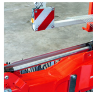
Protection des vérins de repliage
