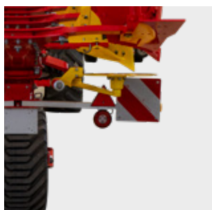
Panneaux de signalisation avec éclairage
