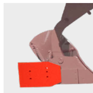
Protection de contresep sur le dernier corps
