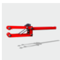
Paralelogramové zavěšení pracovních orgánů
