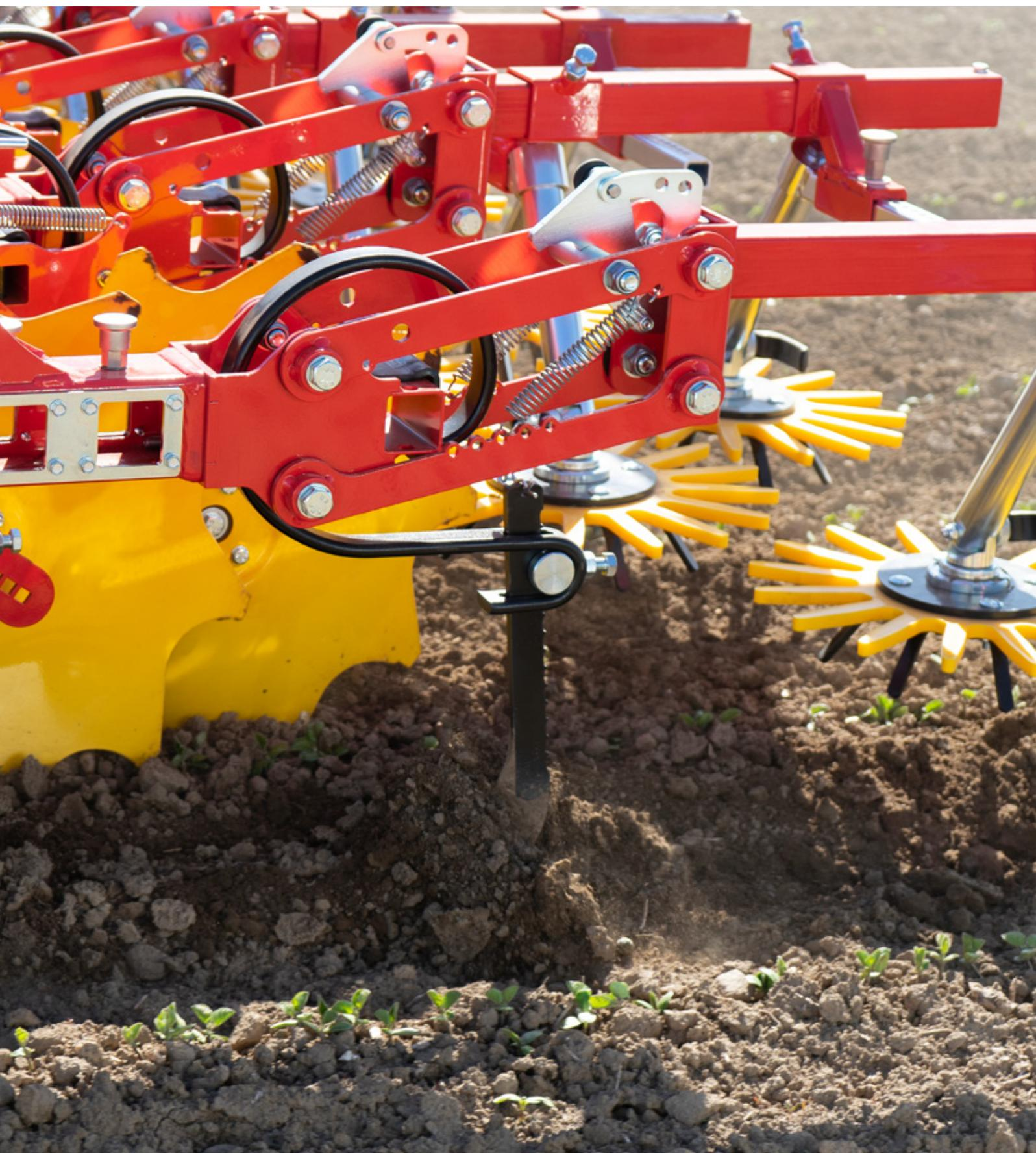
La bineuse FLEXCARE de PÖTTINGER offre, grâce à son concept unique, une polyvalence totale pour pouvoir travailler dans diverses cultures. L'écartement inter-rang, la largeur de travail des éléments et la position précise des dents se règlent totalement sans outils. Les machines se distinguent par un contrôle précis de la profondeur de travail et un travail préservant les cultures.
