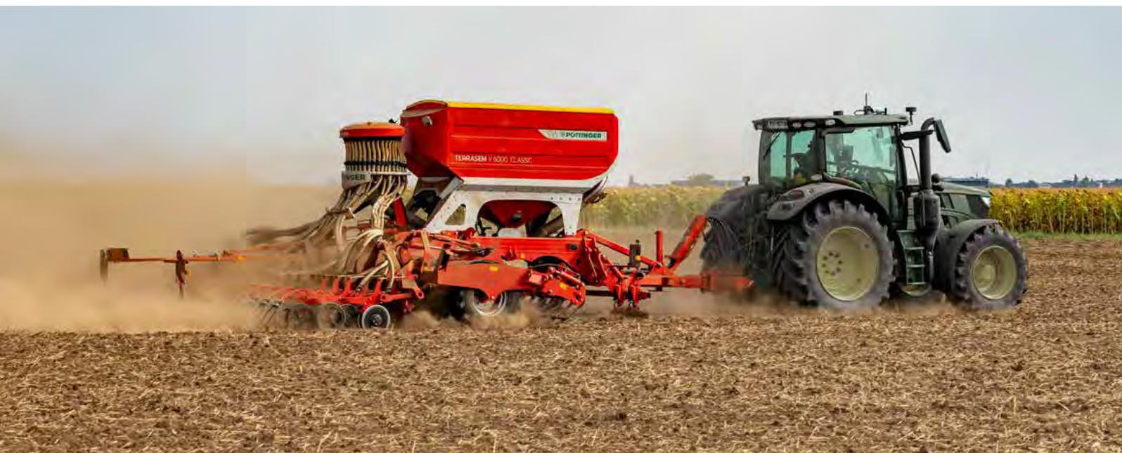
Модели TERRASEM V CLASSIC без передних рабочих органов обеспечивают лёгкую и высокопроизводительную обработку больших площадей.
