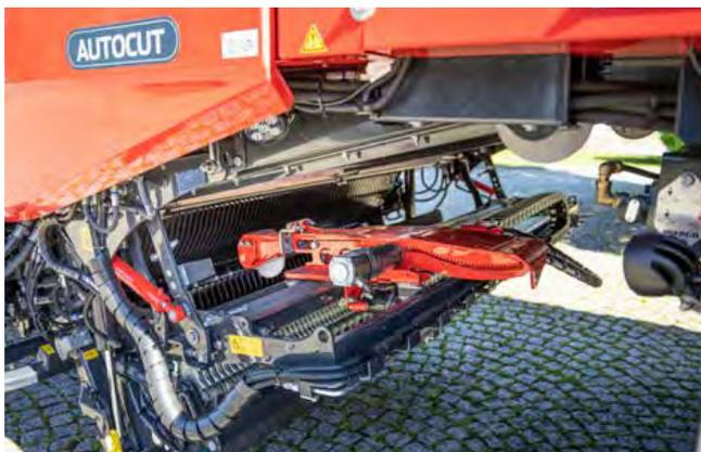
Точная и равномерная резка — это основа высокого качества сенажа. Устройство для заточки ножей AUTOCUT обеспечивает стабильное качество нарезки в течении всего рабочего дня. Ножи удобно и быстро затачиваются прямо на прицепе-подборщике, что значительно сокращает расход топлива и техническое обслуживание.
