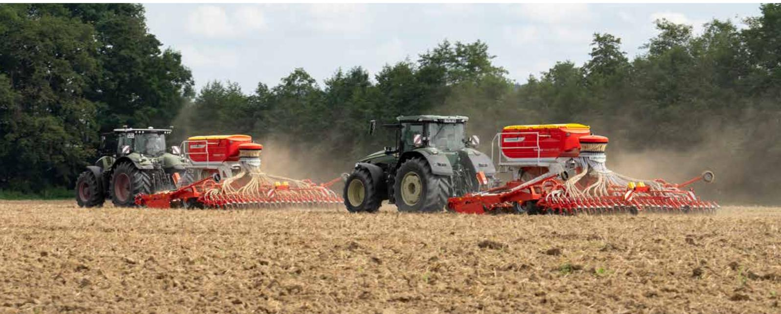
Универсальная сеялка TERRASEM объединяет этапы обработки почвы, уплотнения и посева в одной машине - идеальное сочетание производительности, максимальной безопасности эксплуатации и точности заделки семян, которое удовлетворит любые требования. Дополнительно, система комфортного управления Profiline позволит управлять всеми гидравлическими функциями удобно из кабины трактора.
