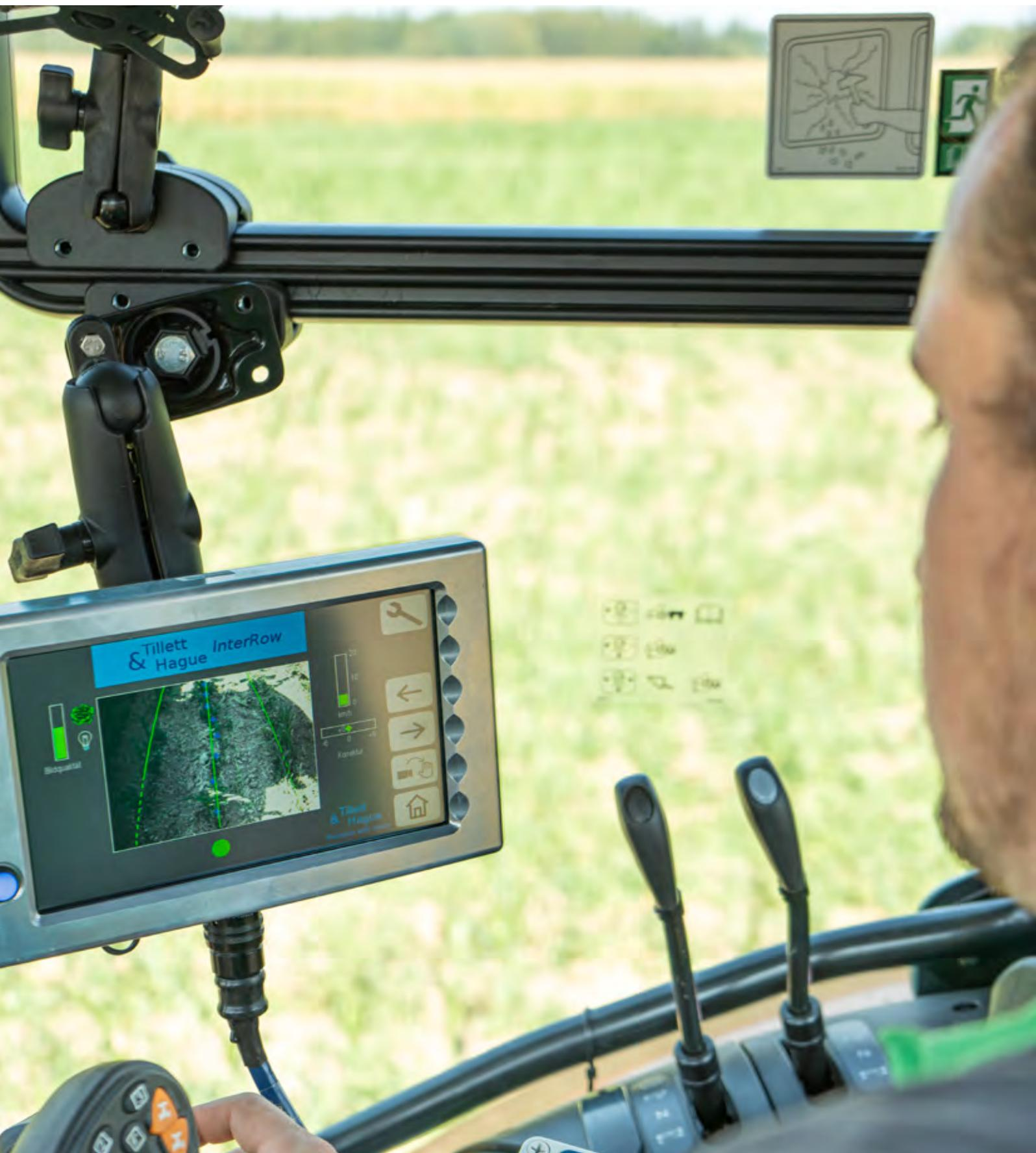
Das Ausheben der Hackelemente am Vorgewende reduziert Überlappungen und Mehrfachbearbeitung. Dazu gibt es zwei Möglichkeiten der Ansteuerung: Zentralaushebung oder Einzelaushebung.
