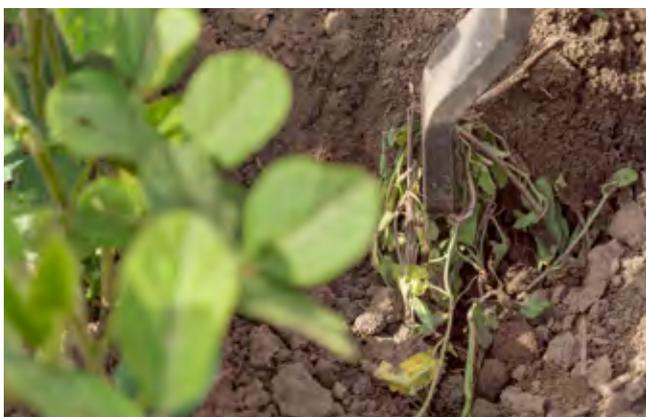
Die Schare selbst werden durch die Hackfeder geführt. Dabei gibt es die Möglichkeit einzelne Schare höher oder tiefer arbeiten zu lassen. In der Praxis werden die mittig am Hackelement montierten Schare häufig tiefer eingestellt. Die Hackfeder bewirkt eine vibrierende Arbeitsweise der Schare, wodurch die Maschine leichtzügiger wird und der Boden besser krümelnd.
