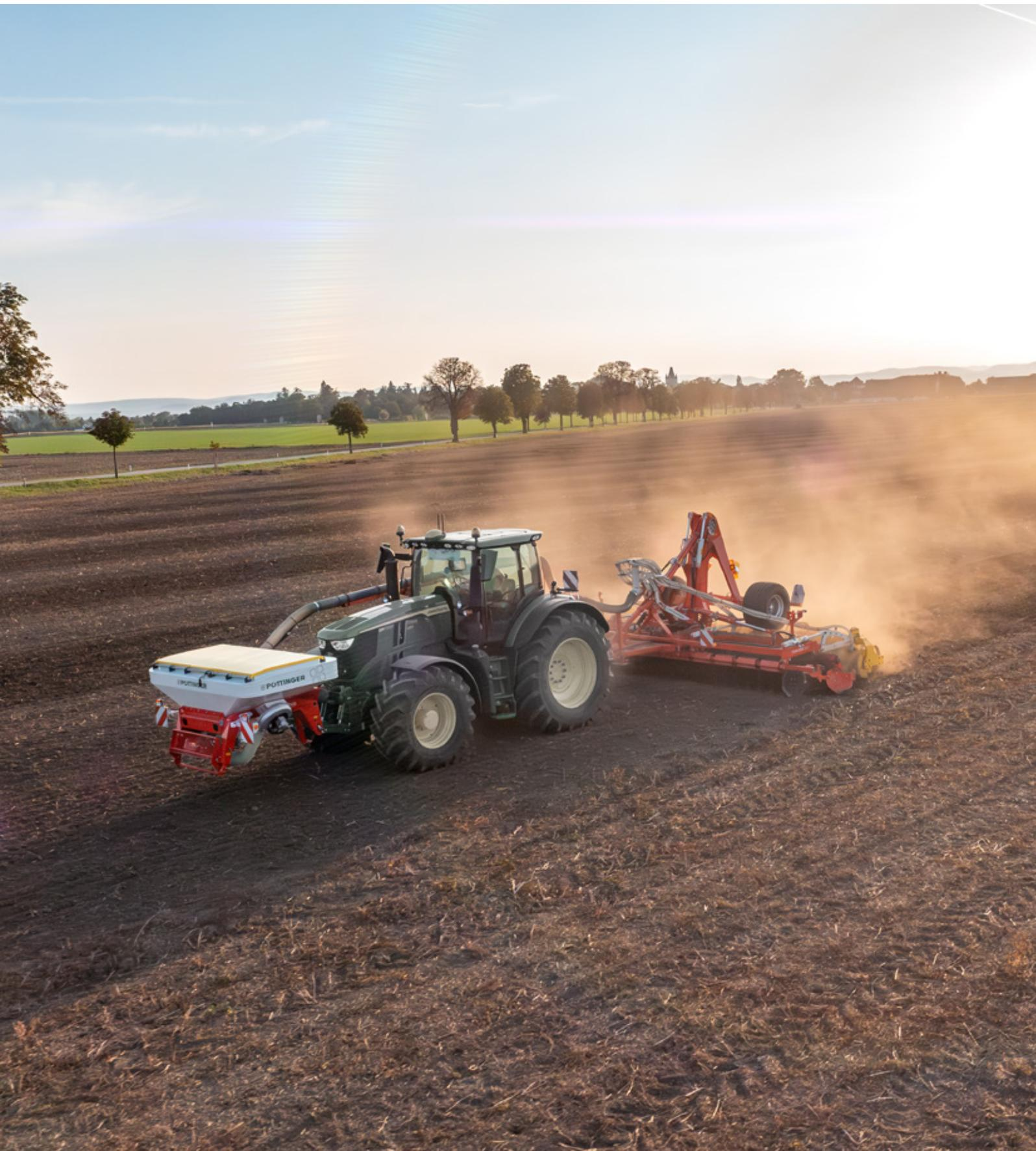
En combinaison avec les déchaumeurs à disques TERRADISC T traînés, les diffuseurs libèrent le produit dans le flux de terre. Le recouvrement immédiat permet d'éviter l'évaporation d'une partie de l'engrais ou de favoriser la germination lors du semis d'un couvert végétal. Même à des vitesses d'avancement élevées, une répartition transversale précise est obtenue et les semences ou l'engrais sont déposés de manière performante.
