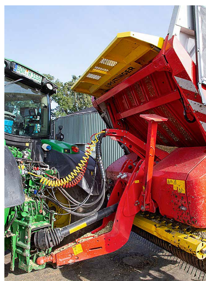
Größte Kritik gilt der Deichselgeometrie. Hier wird es je nach Schlepper eng.
