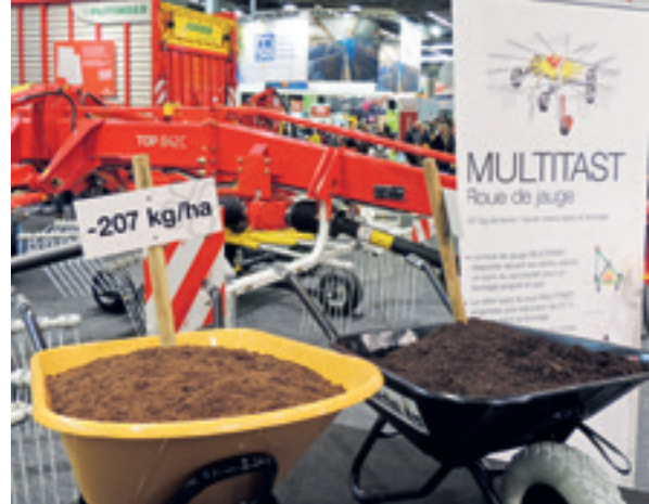
Cette photo du dernier Sima démontre que le système Multitast est toujours d'actualité après deux décennies. La roue de jauge assure une réduction de 25% du taux de cendres dans le fourrage; cela représente 207 kg de produits polluants en moins par hectare.
