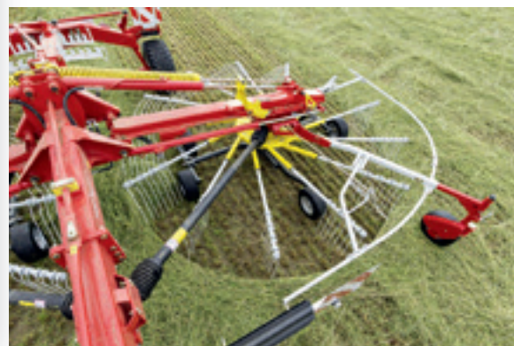
La roue Multitast se trouve devant chaque rotor et fait en sorte que les éléments de l'andaineur suivent le sol de façon précise. Un bel avantage pour épargner les dents.
