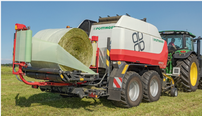
Die Impress von Pöttinger kann als variable Presse bis zu 1,85 m große Ballen pressen. Gewickelt wird bis 1,50 m Durchmesser.
