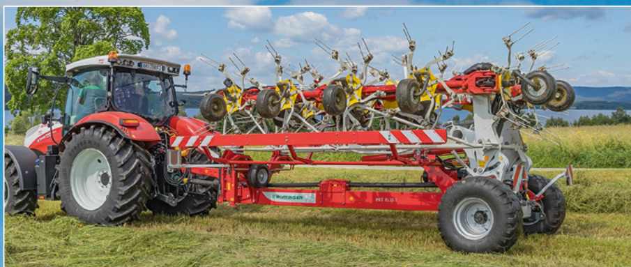
Der Rahmen des HIT 16.18 T wurde verstärkt und um einen Kreiseldurchmesser verlängert.
