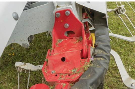
Die Gelenkgabeln der Ausleger sind breiter und massiver konstruiert.
