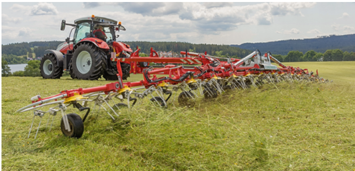
Die Boden- anpassung hat uns im hügeli- gen Ge- lände überzeu- gen können. Nur sechs der 16 Kreisel sind paarweise starr miteinander verbunden.
