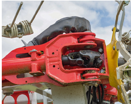
Die Kreisel sind untereinander mit wartungsfreien (Doppel-)Kreuzgelenken oder Fingerkupplungen verbunden.
