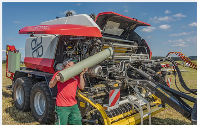
Die Mantelfolie oder das Netz werden seitlich eingelegt.
