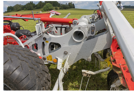
Die Reichtiefe wird komfortabel per Kurbel eingestellt. Die Liftmatic-Funktion ist Serie.
