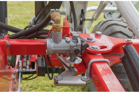
Beim Einklappen betätigt die Kinematik den Bremskraftregler der Druckluftbremse.
