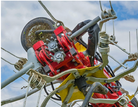
Die Kreisel sind untereinander mit wartungsfreien (Doppel-)Kreuzgelenken oder Fingerkupplungen verbunden.
