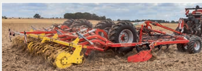
W Terri 6040 ta sama liczba zębów jest rozmieszczona na większej liczbie belek. Więcej miejsc wokół zębów to większa przepustowość.
